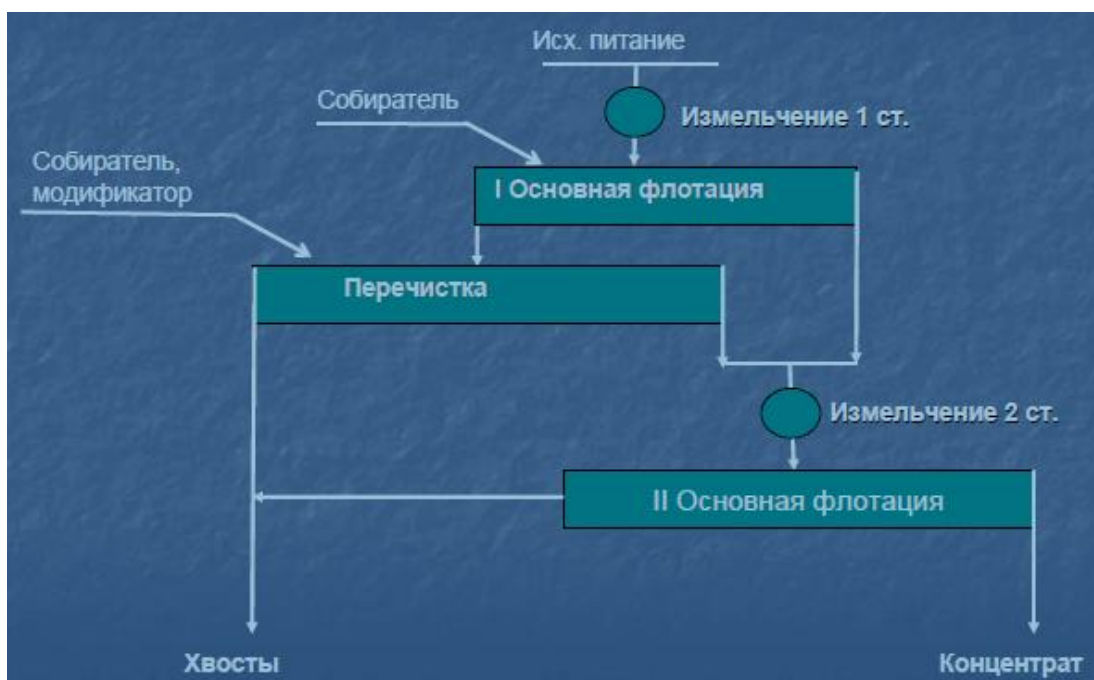
Рисунок 7.10 — Схема двухстадиального флотационного обогащения
