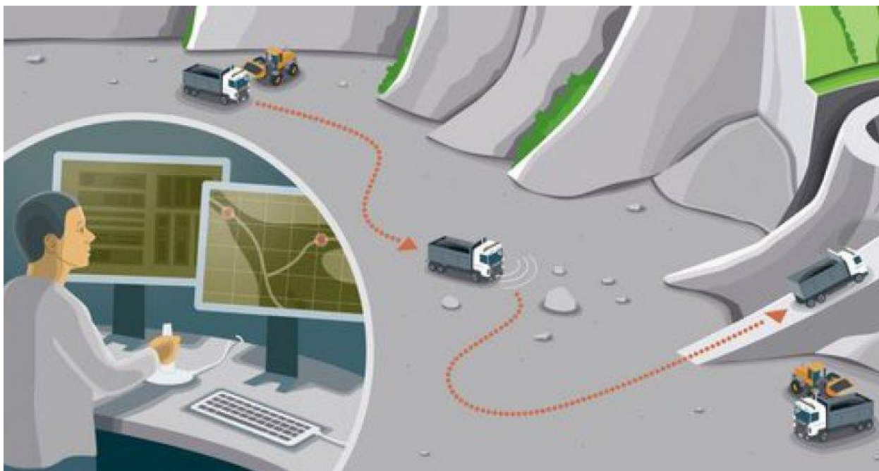
Рисунок 7.3 — Схема управления беспилотными автосамосвалами
