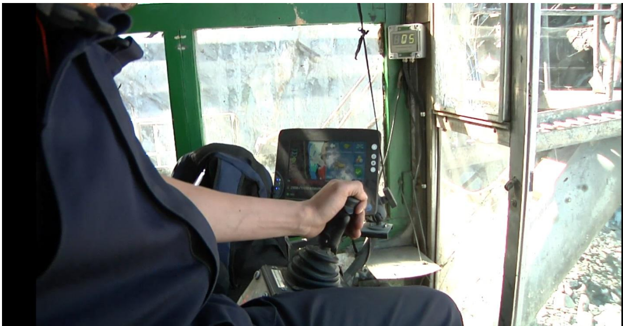
Рисунок 7.5 — Кабина экскаватора, оснащенная системой позиционирования ковша
